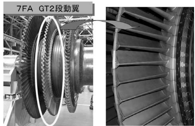
図5 BLE Process™翼の実機組立状況
