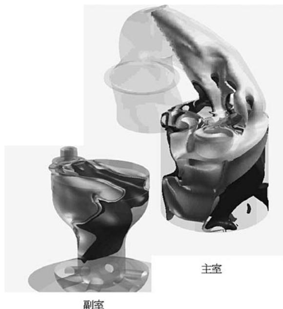
図19 燃焼室CFD解析例
