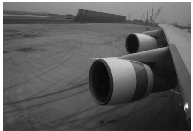
図8 バイオ燃料による地上エンジン作動試験
