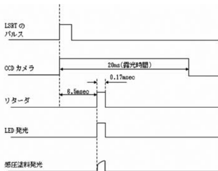
図15 撮影時のディレイ回路による制御
