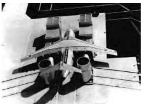
(a)エンジン・エンクロジャー型 (C1向け)
