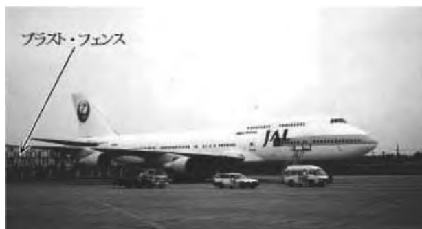
図1 屋外ランナップ場（プラストフェンス）
