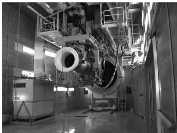
図5 ESPRターボエンジンの運転風景
