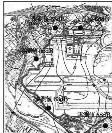
図8 騒音コンターマップ（予測値）と実測値 航空機A（#2エンジン:Take Offパワー）
