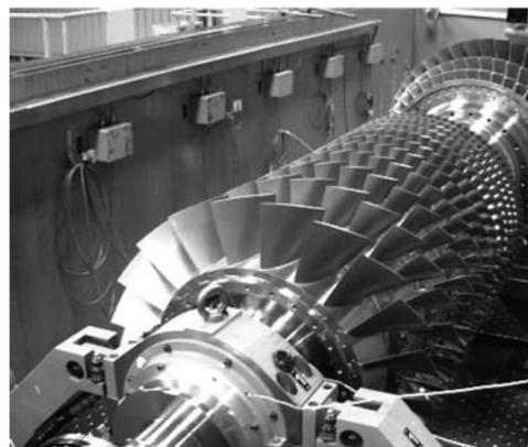
図9 高速バランス装置に入ったロータ
