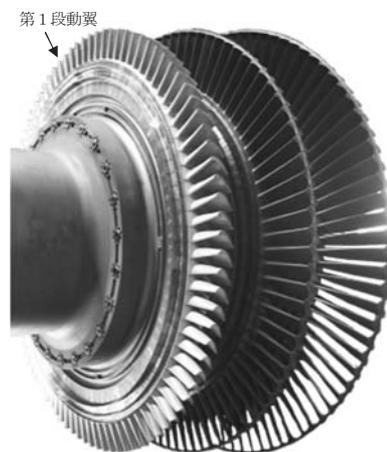
図1 ガスタービンロータ（タービン部）
