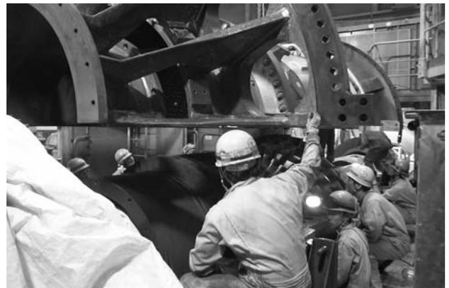
図9 ガスタービン車室のつり込み
