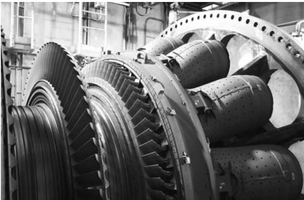
図6 燃焼通路～第1, 2, 3段動翼
