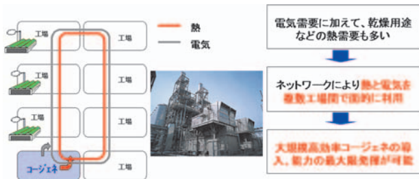
図7 コージェネレーション排熱の面的利用
