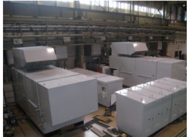
図7 CNT-6000EN 発電装置 (2台並列)
