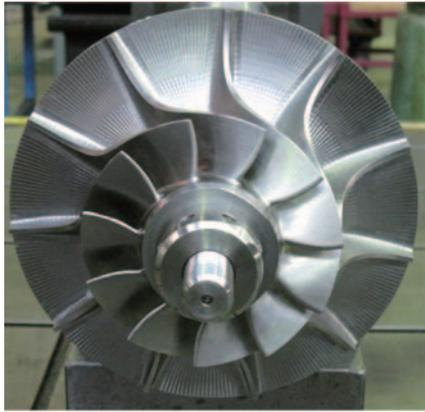
図5 高圧タービン翼車の概観
