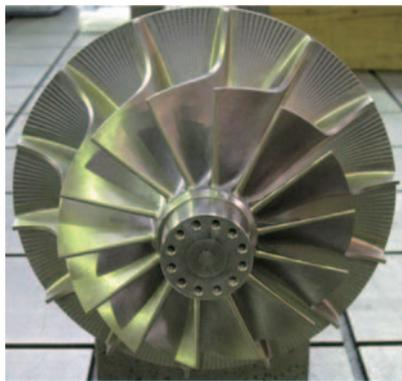
図6 低圧タービン翼車の概観
