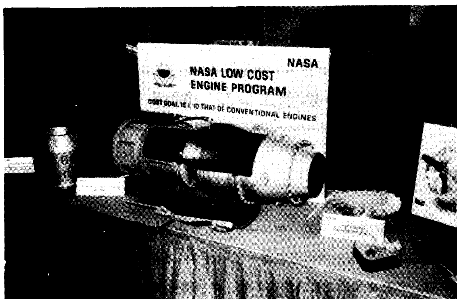
(写真1) NASAの低価格エンジンの展示、右が板金製の圧縮機ホイール、左がルーバーのないアニュラー型燃焼筒
