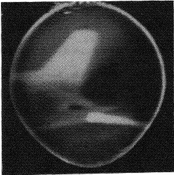
写真3 エア・バスの尾部エンジンの排気ガスの赤外線放射パターン
