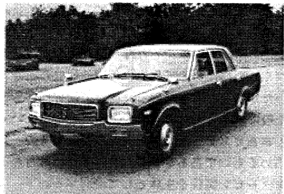
図7 GT54を搭載したトヨタセンチュリーガスタービンハイブリッド実験車
