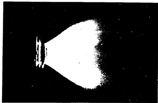
写真2. 旋回ジェット火炎の直接写真( $\phi_0=0.98$ )
