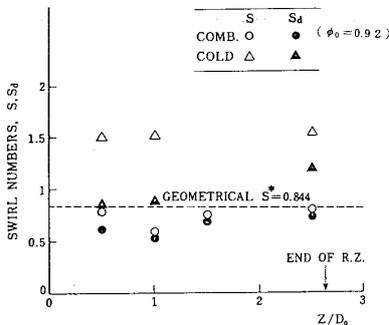
図5. スワール数の軸方向変化
