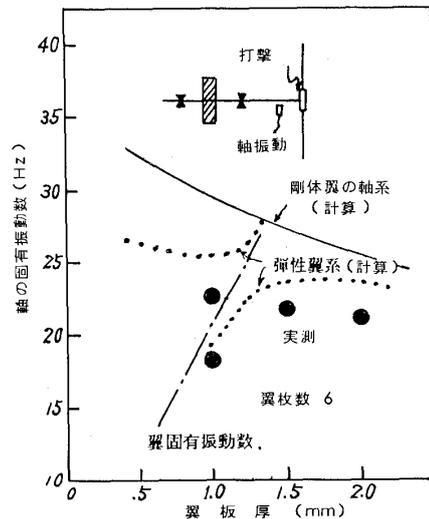
図6 翼の固有振動数 (静止時)
