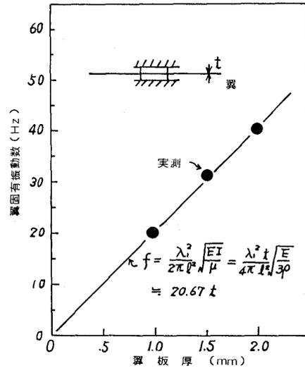
図5 翼の固有振動数 (静止時)
