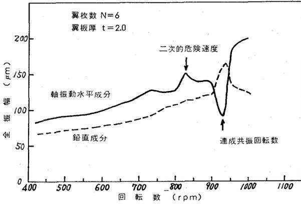
図11 不つりあい軸振動実測
