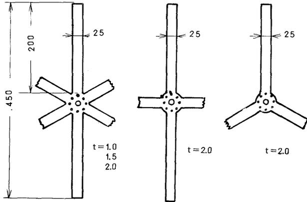
図4 試験翼形状
