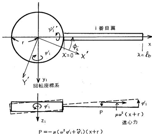
図 2 翼に作用する加振力
