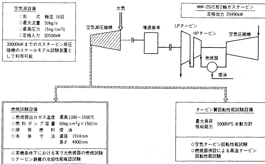
図5 ガスタービン用大形試験設備の構成と主要目
