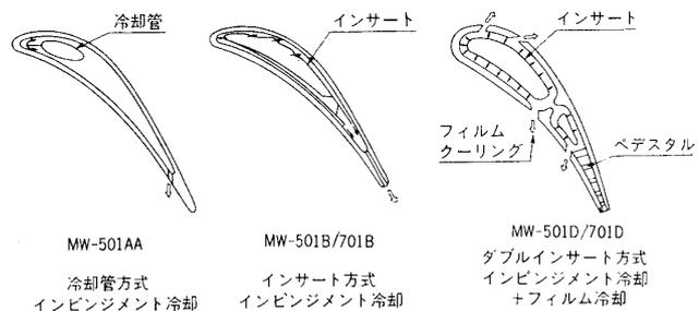
図1 大容量ガスタービン翼の冷却方式
