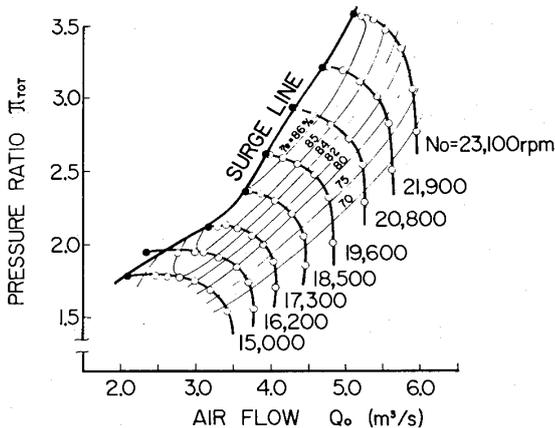
図3. 最近の過給用遠心圧縮機代表性能
