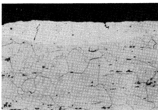
図21. Ni合金の電解加工時の短絡による クラックと変質層
