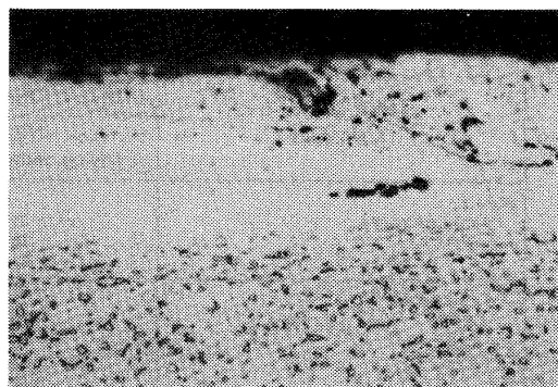
図7. Ti合金のガンドリル加工軸芯を含む断面
