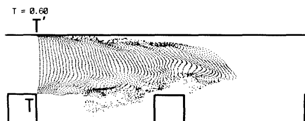
図4 コンピュータによるタイムライン ( Re = 1.1 \times 10^4 )
