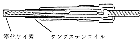
図8. セラミックグロープラグの構造
