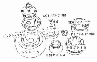
写真1 CGT 303 用セラミック静止部材
