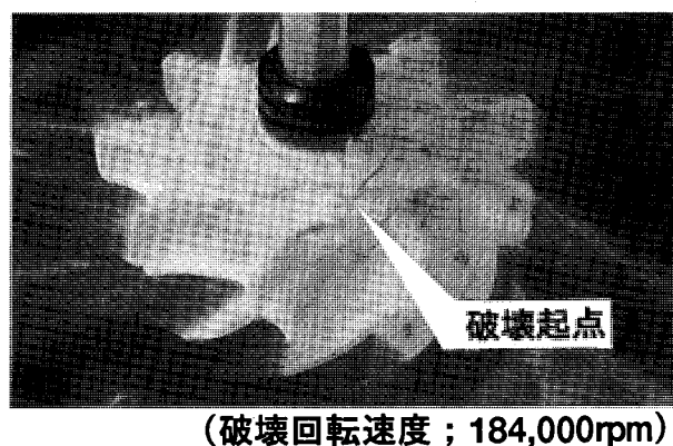
図10 モデルIの破壊瞬間
