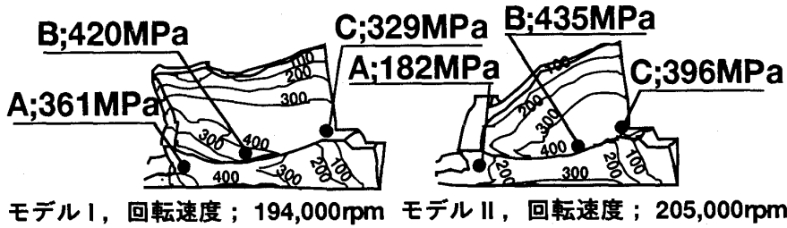
図 12 平均破壊回転速度での応力分布
