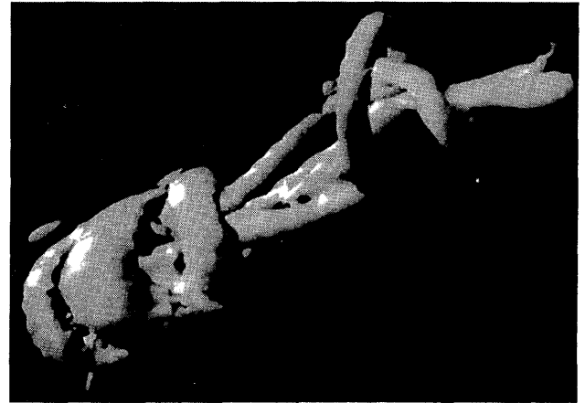
図3 粒子近傍の流れの解析 (直角座標格子による簡易解法による再現例)
