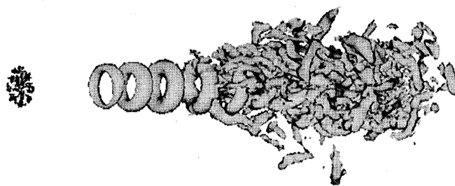
図5 円形噴流のDNSによる渦度場 ( \Delta p の等値面による低圧領域の表示)
