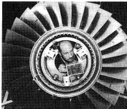
図5 Rolls-Royce 社リフトファンのチタン製ブリスカ (6)
