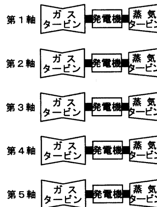
図4 対象のガスタービン複合発電プラント
