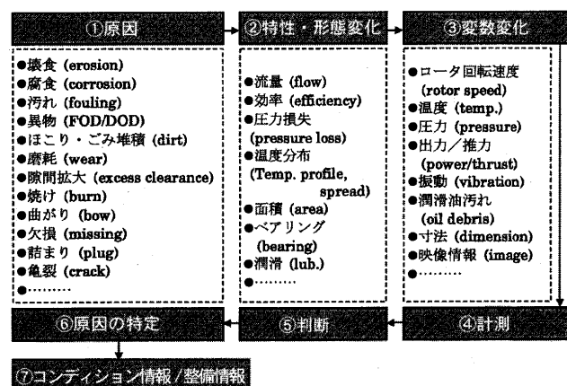
図3 モニタリングの原理 3)
