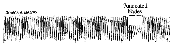
図13 パイロメータによる翼ごとの温度 18)
