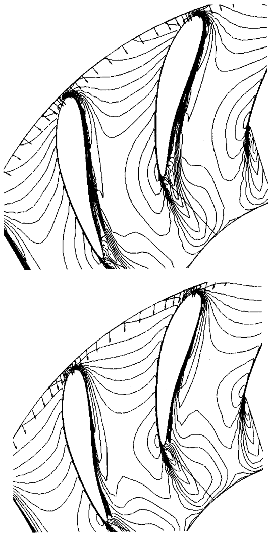
図13 動翼内の相対マッハ数分布（流量重視設計タービン、上： U/C_0=0.6 、下： U/C_0=0.7 ）
