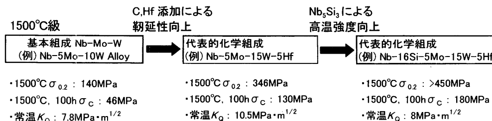
図1 1500℃級Nb基複合材料の設計と高温強度
