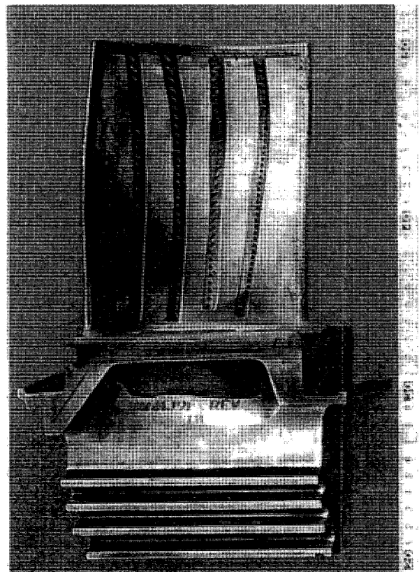
図 6 MGA 1400 を用いて作成された 1500℃ 級ガスタービン第一段 DS 動翼
