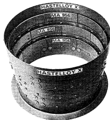
写真5 MA 956を使用した高温燃焼筒
