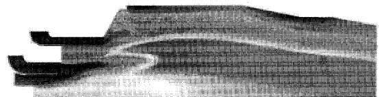
図9 KIVA コードを用いた燃焼器内部の燃焼流体 CFD 解析結果 (温度分布)
