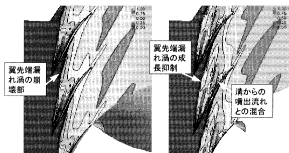
図7 周方向トリートメントを考慮した複雑形状解析例
