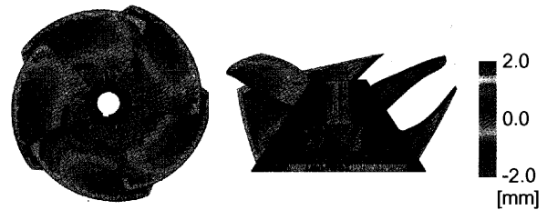
図4.5 ポンプインペラ試作品の設計データとの寸法比較
