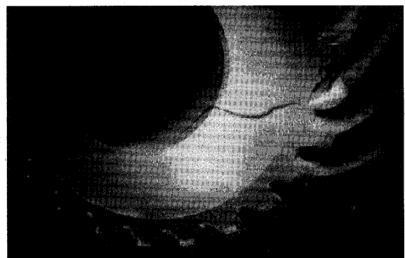
図11 ギヤ歯元から軸部に進展した亀裂の例 (1)
