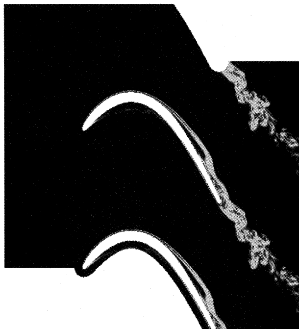
図4 剥離を伴う低圧タービン翼まわりの LES 解析
