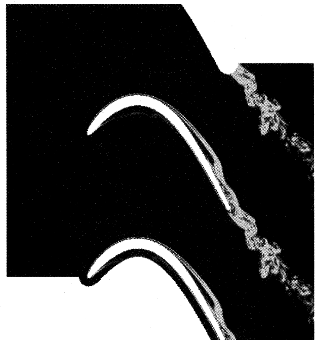
図4 剥離を伴う低圧タービン翼まわりの LES 解析
