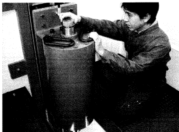
写真6 GALCIT空気銃 (全長2m, 砲身径50mm)
