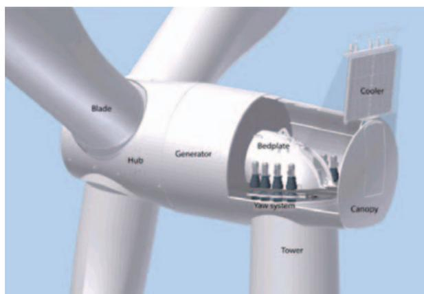
図9 ギヤレス風車の例<sup>20)</sup>
