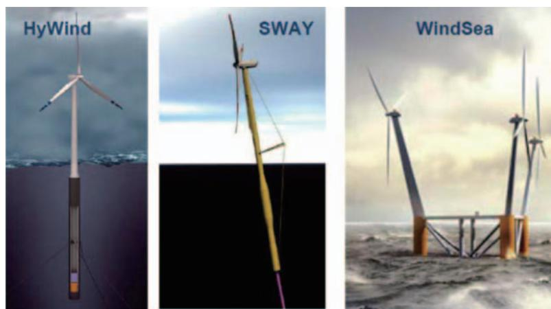
図8 ノルウェーの将来の浮体式洋上風車 (IEA Workshop資料より)
