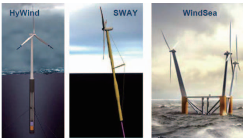
図8 ノルウェーの将来の浮体式洋上風車 (IEA Workshop資料より)
