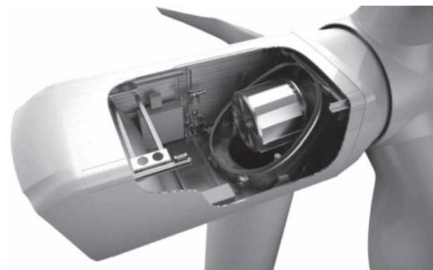
図8 中速PMSG風車の例<sup>20)</sup>
