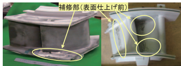
図12 拡散ろう付け補修静翼（表面仕上げ前）
