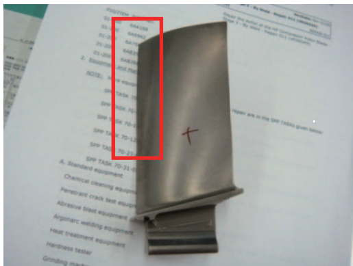
図3 V2500型エンジン 高圧圧縮機第4段ブレードDER Repair適用例（前縁部への溶接修理はメーカーマニュアル上は不可）
