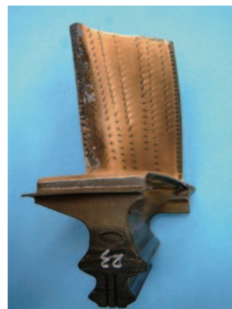
図2-2 GE90-115B高圧第1段タービンプレード 単価：約190万円
