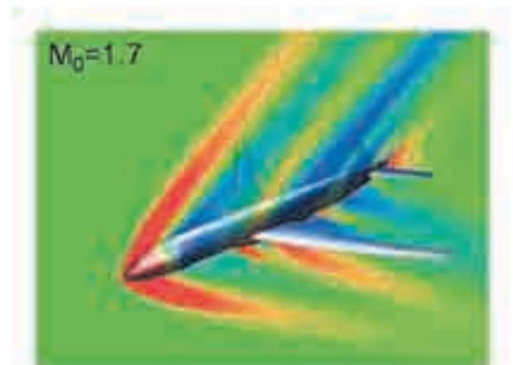
超音速流れと衝撃波の例 (本文 図 4 参照)
