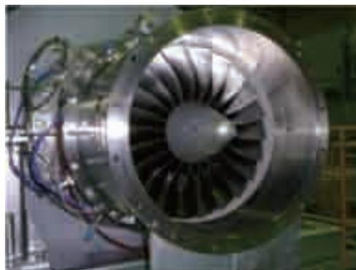
図1 JAXA遷音速ファン供試体
