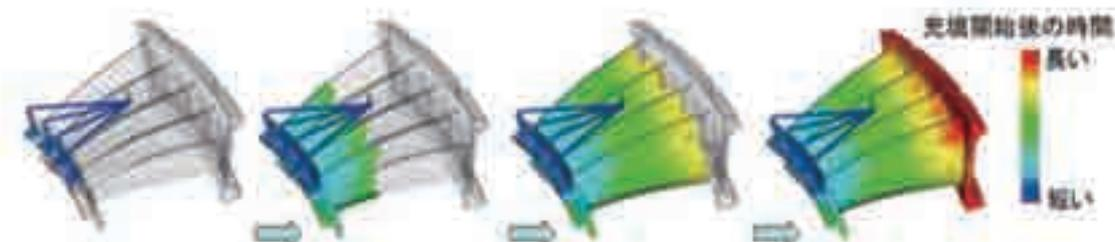
精密鋳造翼のワックス流れ解析 (充填状況)
