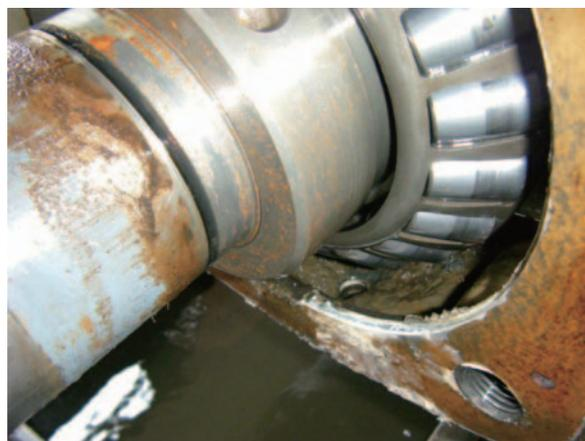
主ポンプ外軸受内部の砂除去前
