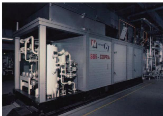
Fig. 1 三井SBシリーズ（型式SB5，1MW）
