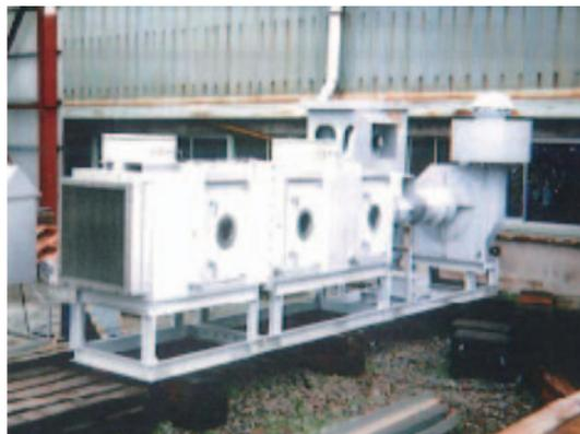
Fig. 8 F社フィルタ圧力損失用試験装置
