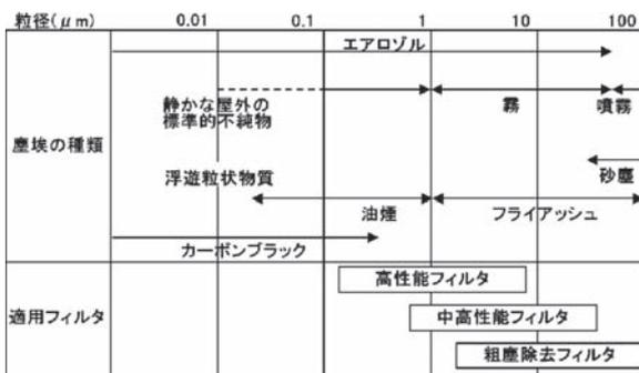
Fig. 3 捕集するダストの粒径と吸気フィルタの関係
