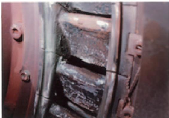
Fig. 7 F社1段静翼腐食状況
