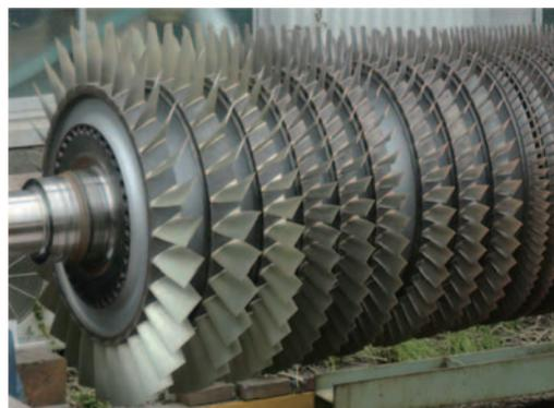
Fig. 2 HEPAフィルタ導入後の圧縮機開放点検事例
