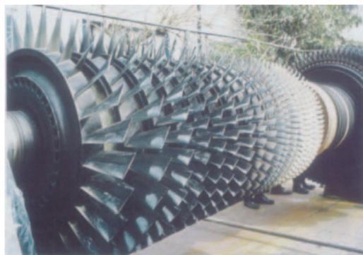
Fig.22 放水冷却実施後のガスタービン開放点検
