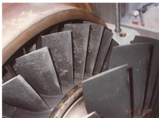
Fig.14 Nuts洗浄直後の圧縮機汚れ写真
