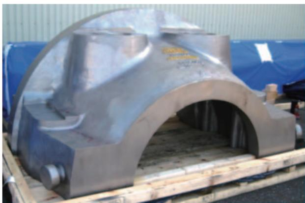
Fig. 9 Ni基鋳鋼ケーシング試作品
