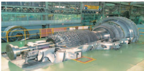
Fig. 2 製作工場でのMW-701Dガスタービン
