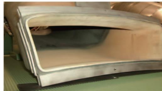
Fig. 6 出口部全面にTBC施工した燃焼器尾筒
