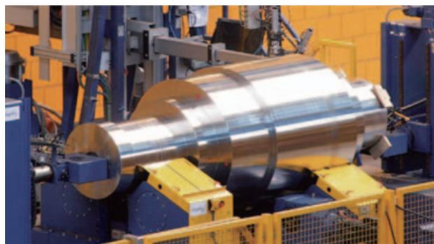
Fig. 7 A-USC用Ni基試作ロータ
