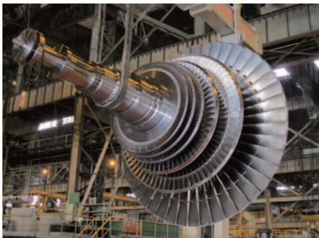
Fig. 5 試験用低圧ロータ
