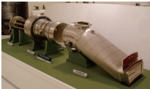
Fig. 9 新型燃焼器（マルチノズル型）
