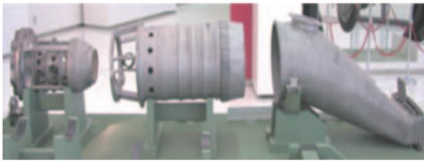
Fig. 4 乾式予混合型低NOx燃焼器
