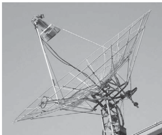
手作りのパラボラ・アンテナ (直径4.8m)
