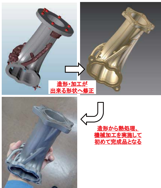
Fig. 12 トポロジー最適化による部品設計の流れ
