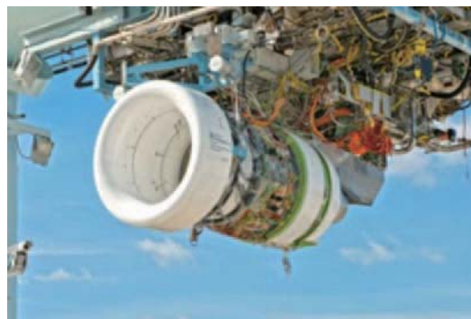
Fig. 15 PW1200G地上試験 (6)
