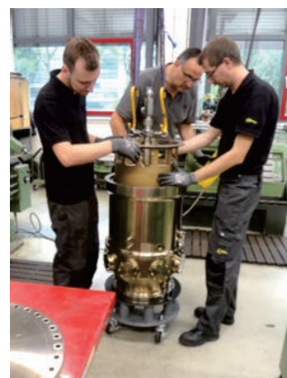
Fig. 4 水素専焼ドライ低NO x 燃焼器の部品交換作業をするIKDGのワークショップ
