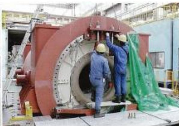
図14 発電機組み立て作業
