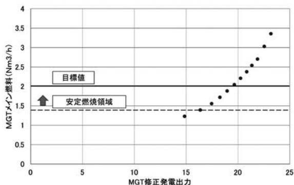
(MGT修正発電出力：大気15℃条件に修正したMGT発電出力)
