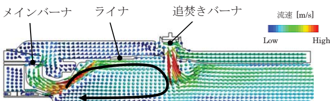
図4 メイン燃焼領域におけるフローパターン
