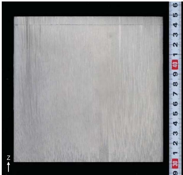
図3 試作単結晶板材のマクロ組織観察
