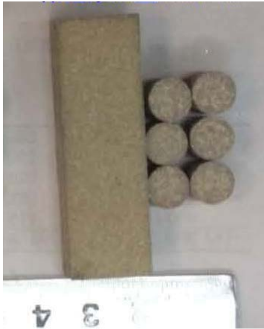
図5 試作した新 CMC の外観と断面組織
