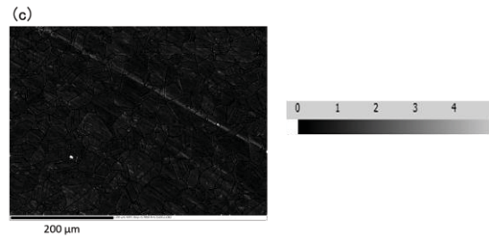
Fig. 7 KAM map of PF SHT specimen.
