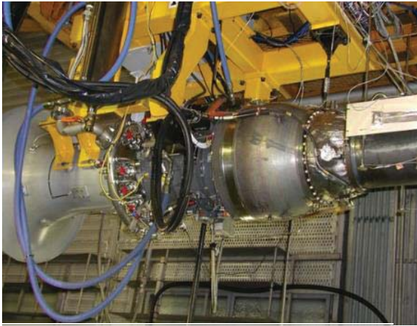
図4 水噴射ダクトを装着したジェットエンジン 13)
