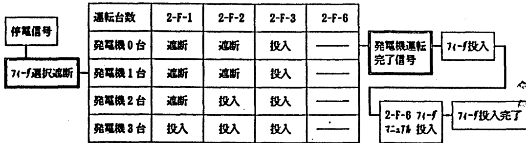
発電機の運転台数による発電機71-fの選択遮断、投入
