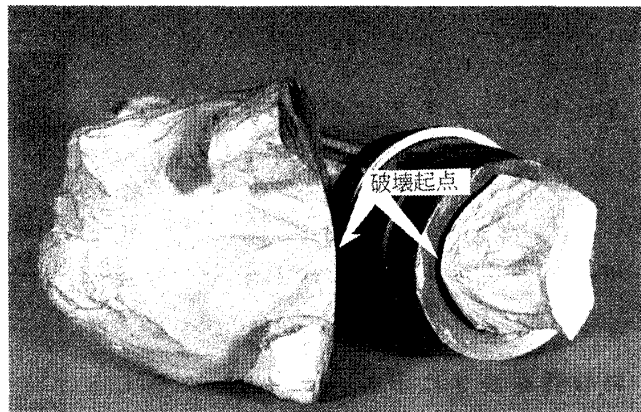
(破壊回転数:105000rpm, 破壊起点:A部)
