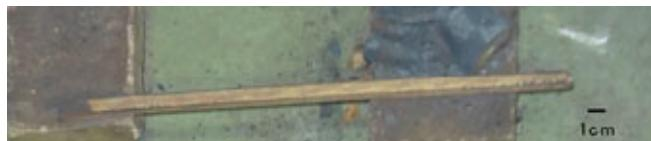
図 2 開発高純度鉄基鍛造合金の溝ロール圧延材の外観
