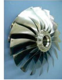
Fig. 3 JAXA 50cm ファン改良型動翼<sup>(3)</sup>
