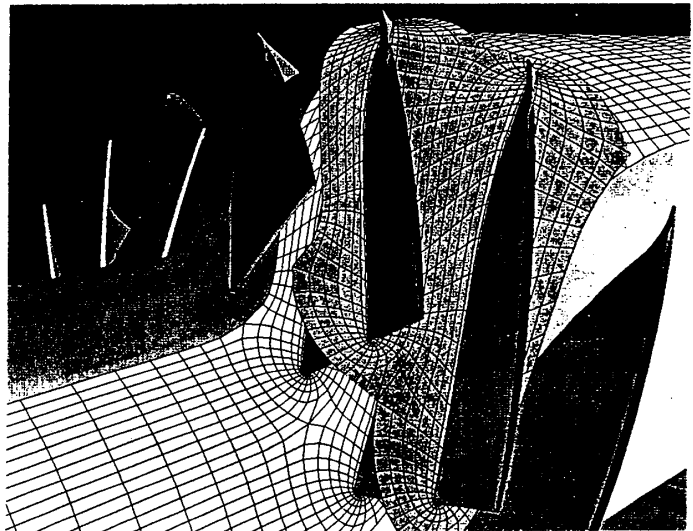
図4 数値シミュレーションによる 圧縮機翼列の設計
