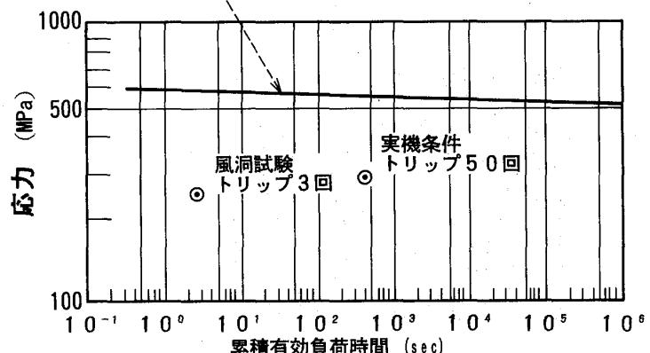
図1-5 セラミック静翼の統一的強度評価
