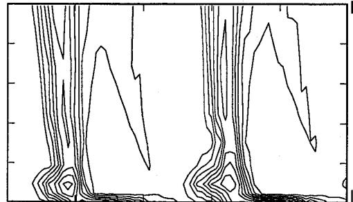
図 29: C2 損失分布図 (実験値, 0.5 翼弦長下流)
