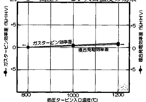
図-6 低圧タービン入口温度の効果
